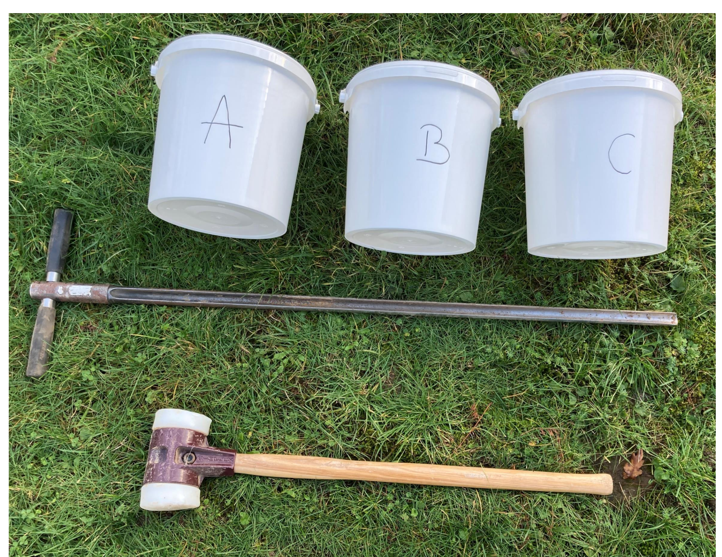
Abb. 1: Pürckhauer-Borstock, Schonhammer und saubere gekennzeichnete Eimer für drei Entnahmetiefen (Foto: LHL)
